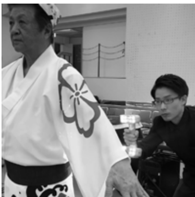
図5 全身を3Dスキャンして3Dモデルを作成する
